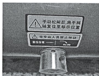
图 3 手动松闸复位警示标签
