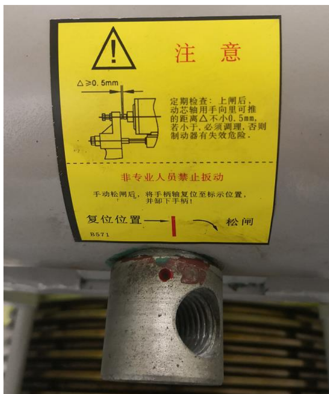
手动松闸装置操作复位说明标签
