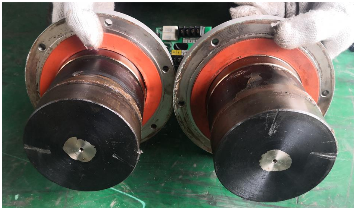
600 次手动松闸试验后的铁芯端面
